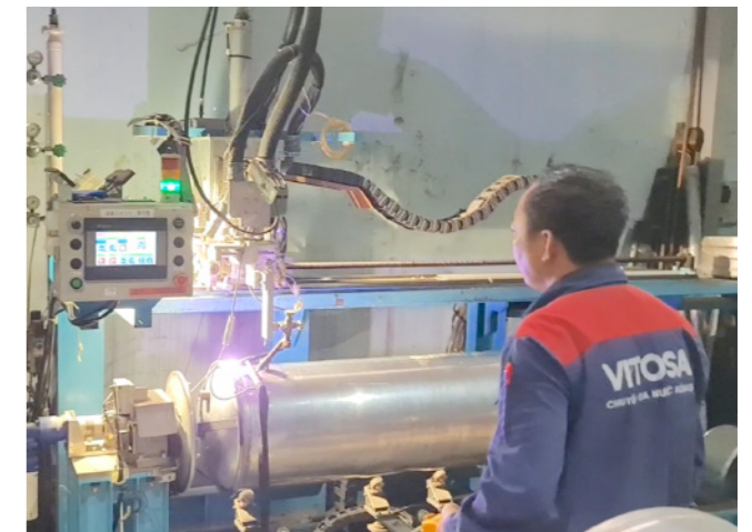
Hàn tig lạnh tự động bình chịu áp kín
