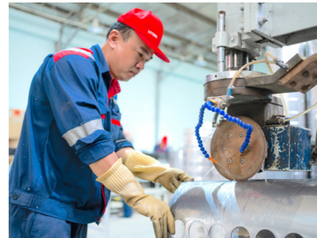
Hàn xung điện cực ruột bình bảo ôn
